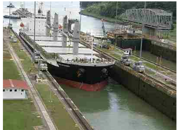
Der ist bereits durch die Schleuse durch – der andere wird gerade mit den Lokomotiven reingeschleppt.
