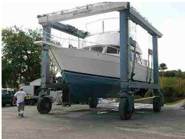
Der Kran hat sie aus dem Wasser gehoben, sofort wird das Unterwasserschiff gereinigt und dann steht sie an Land
